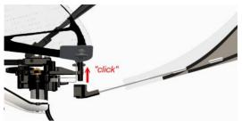
Führen Sie das Ende des Ruders ein, indem Sie es auf das Rohr am Ende des Steuersystems drücken, während Sie den oberen Teil dieses Rohrs mit dem Zeigefinger der anderen Hand halten, um die Kraft auszugleichen. Spreizen Sie gegebenenfalls die Enden der Feder auseinander; sie sollten außerhalb des Ruderendes bleiben.
